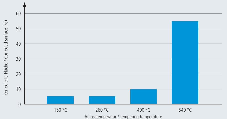
Für höchste Korrosionsbeständigkeit niedrige Anlasstemperaturen verwenden. Tiefkühlen sollte vorgesehen werden.
